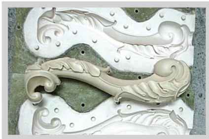
Силиконовый компаунд для изготовления форм с твердостью по Шору 30, для увеличения прочностных характеристик наполненный Аэросилом, используется для изготовления форм со сложной конфигурацией. В формы из Силагерм® 7230 производят заливку эпоксидных, полиэфирных смол, гипса, воска, ПУ пластиков и т.п. Компаунд через 20–30 минут после смешивания теряет текучесть и его можно наносить на вертикальные и наклонные поверхности.
