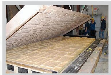
Формы наилучшего качества получаются при заливке под кожух. В этом случае модель по поверхности выкладывается воском или пластилином, обычно по толщине 7–10 мм. Сверху заливается кожух. После отверждения кожуха и снятия воска между моделью и кожухом образуется равномерный зазор, куда и заливается или нагнетается формовочный материал.
