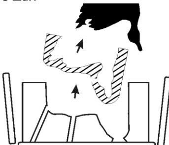
Разберите короб. Достаньте гипс и сделайте в нем одно отверстие для заполнения и несколько для выхода воздуха. Удалите пластилин и фольгу с оригинала.
