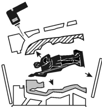
Разберите короб. Достаньте гипс и сделайте в нем одно отверстие для заполнения и несколько для выхода воздуха. Удалите пластилин и фольгу с оригинала.
