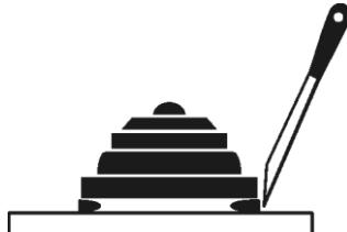
Поместите полоску пластилина на дно короба по контуру нижней стороны оригинала. Вдавите нижнюю сторону оригинала в пластилин. Удалите весь выступающий пластилин.
