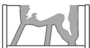
Соберите силиконовую форму и гипсовую подложку в формовочном коробе на плоской горизонтальной поверхности.
