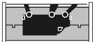
Начинайте медленно заливать заливочный материал в форму через воронку, вставленную в пластиковую трубочку заливочного отверстия. Держите контейнер как можно ближе к воронке. Продолжайте до тех пор, пока не заполнятся пластиковые трубы отверстий для выхода воздуха. Слегка потрясите форму, чтобы материал распределился по всем неровностям формы и все пузыри воздуха вышли через отверстия.
