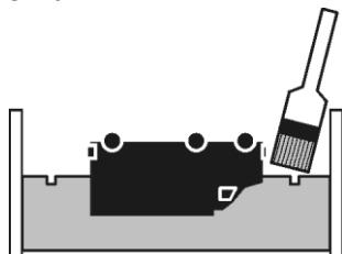
Соберите короб обратно и покройте поверхность силиконовой формы внутри него разделительной смазкой, например парафином, воском или мыльным раствором. Силиконовыми смазками в этом случае лучше не пользоваться..
