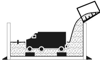
Оберните половину оригинала в алюминиевую фольгу (ту половину, которая окажется внизу при помещении оригинала в короб) и поместите его в короб на деревянных подставках (высота по 1 см). Залейте растопленный пластилин в короб до половины оригинала – до уровня, где кончается фольга.
