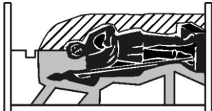
Соберите короб обратно и покройте поверхности силиконовой формы и гипса внутри него разделительной смазкой, например парафином, воском или мыльным раствором. Силиконовыми смазками в этом случае лучше не пользоваться. Покройте оставшуюся часть оригинала алюминиевой фольгой, а поверх нее – толстым слоем пластилина или глины (не менее 1 см).
