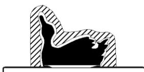
Покройте оригинал алюминиевой фольгой, а поверх нее – толстым слоем (не менее 1 см) пластилина или глины.
