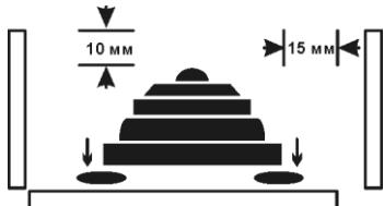
Подготовьте формовочный короб из дерева, пластика или металла. Зазор вокруг оригинала должен быть не менее 15 мм. Расстояние от верхней точки оригинала до верха короба – не менее 10 мм.
